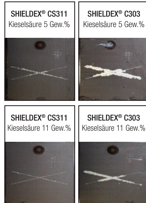
Abb. 3: Ergebnisse der Salzsprühnebelprüfung über einen Zeitraum von 1.000 Stunden an einem Polyester-Coil-Primer mit Decklack, pigmentiert mit SHIELDEX® CS311 und SHIELDEX® C303, Pigment-Zusatzmengen von 5 Gew.% und 11 Gew.%.
